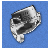
Abb. 18 : erstes IdO Hörgerät „I 11 V“ von Oticon, nach Oticon, 2010
